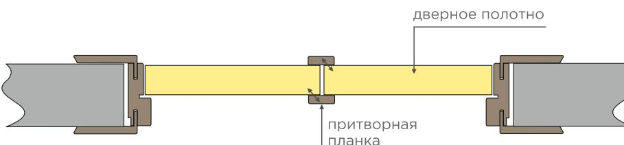
Коробка в сборе без добора. Представлен вариант установки распашных дверей с применением притворной планки.
